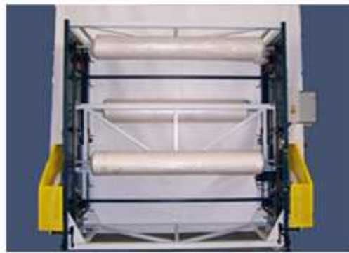
Acumulador y transportador de bobinas
