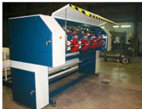
Cortadora de tejido longitudinal y transversal
