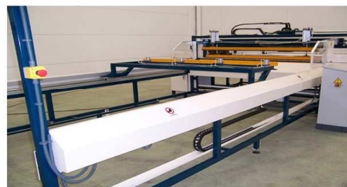
Troqueladora y cortadora automática
