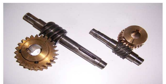
Coronas y sinfin para reductores y transmisores
