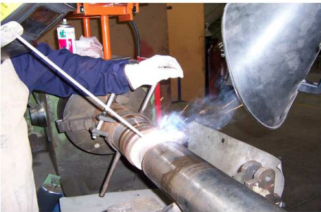
Soudage dans les bars d'injection
