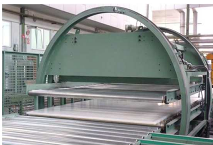
Sistema de transporte y volteado a 180°
